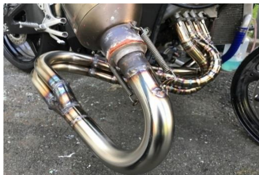
エキゾーストパイプ溶接部
