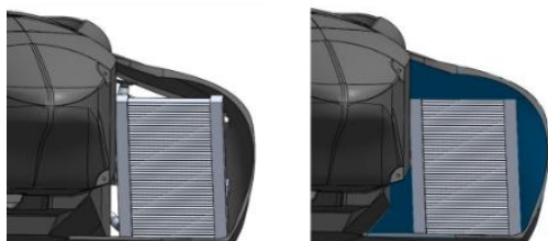
ブロック体なし ブロック体あり サイドポンツーン内のブロック体
