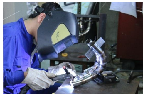
集合部の溶接作業
