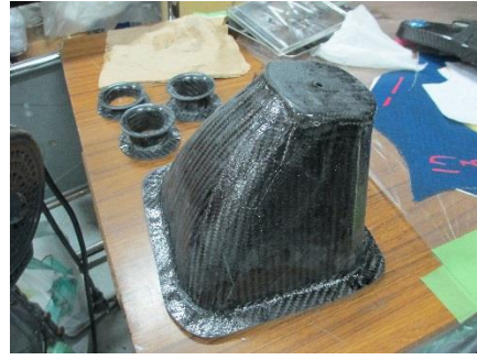
サージタンクとファンネルの完成品
