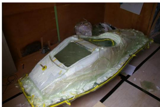
真空状態になったら、焼く工程へと移ります。スポンサー様のオートクレープをお借りし、圧力をかけたまま数時間で焼き上げます。
