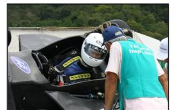
タンにし、重量計測が行われました。空車時の重量はなんと195kg。恐らく今大会4気筒エンジン搭載車両の中では最軽量ではないでしょうか。チルト(傾斜)検査では4
